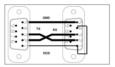
Pin 1) →DCD Pin 2) →RX Pin 3) →TX Pin 5) →GND
